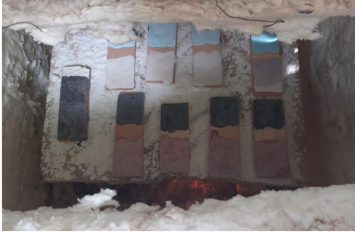
شكل رقم (2) يوضح الفرن الغازي مع العينات المطلوبة. شكل رقم (3) الوعاء المعدني مملوء بشارة الخشب
