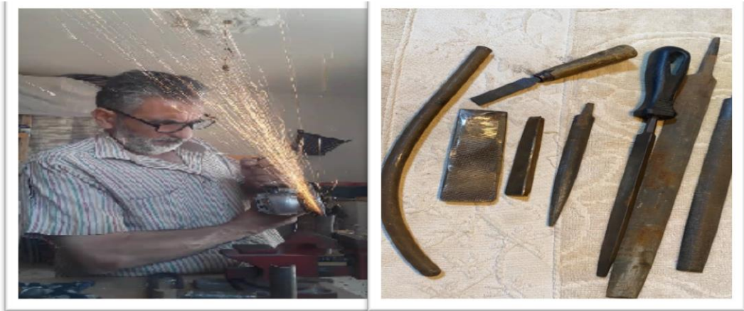
صورة (18-19) قص قطعة الخردة إلى مناقير بالمنشار الكهربائي .
